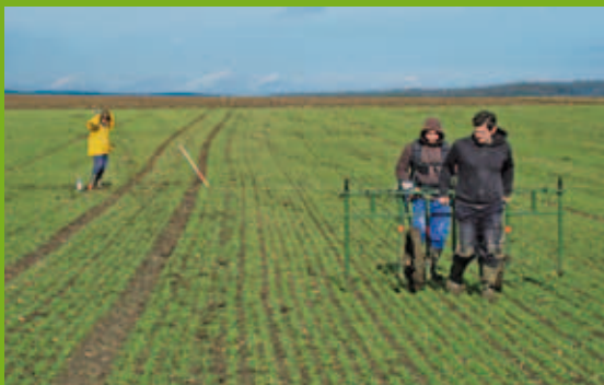
Studenten der Universität Kiel bei der geomagnetischen Prospektion mit einem vierkanaligen Fluxgategradiometer in Theilenhofen.
