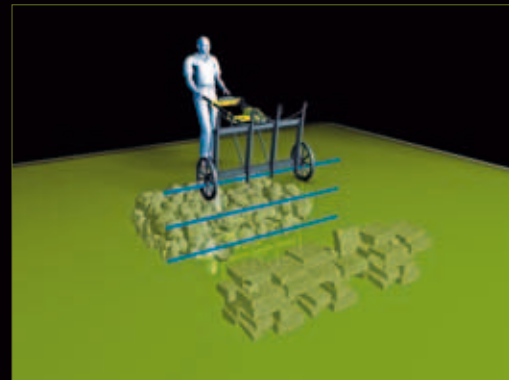
Schematische Darstellung des Einsatzes eines vierkanaligen Fluxgategradiometers.
