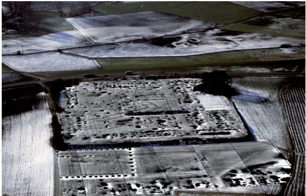
Abb. 8 Pförring. Das römische Kastell im Luftbild mit aufgelegtem Magnetbild. Cäsium-Smartmag SM4G-Spezial-Magnetometer, Duo-Sensor-Anordnung, Dynamik \pm 16,00 nT in 256 Graustufen, Empfindlichkeit \pm 10 pT, 0,50 \times 0,25 m Messpunktabstand, 40-m-Gitter, Auswertung als Quadrantenmittel.
